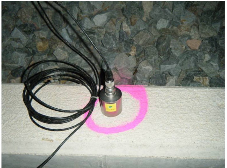
Fotografía N°5: Acelerómetro empleado en la prueba
