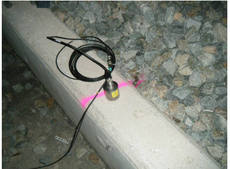
Fotografía N°1: Acelerómetro empleado duran- te la Prueba.
