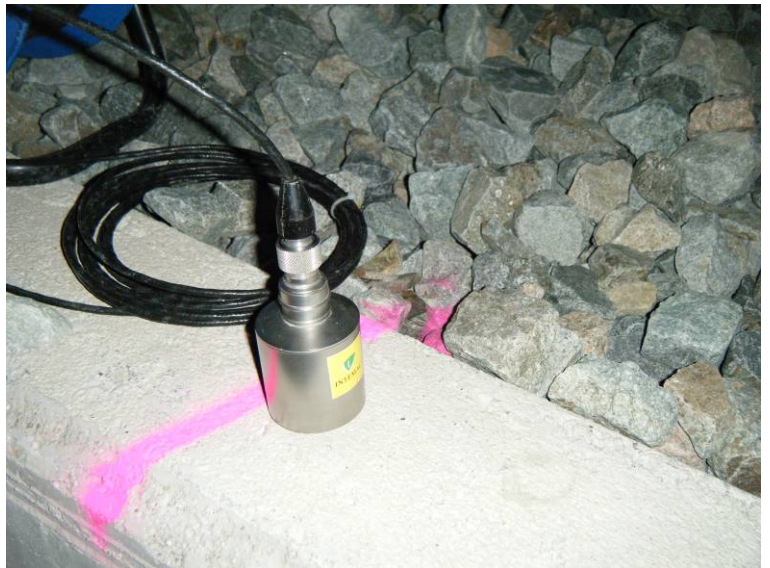
Fotografía N°2: Detalle del acelerómetro em- pleado durante la Prueba.
