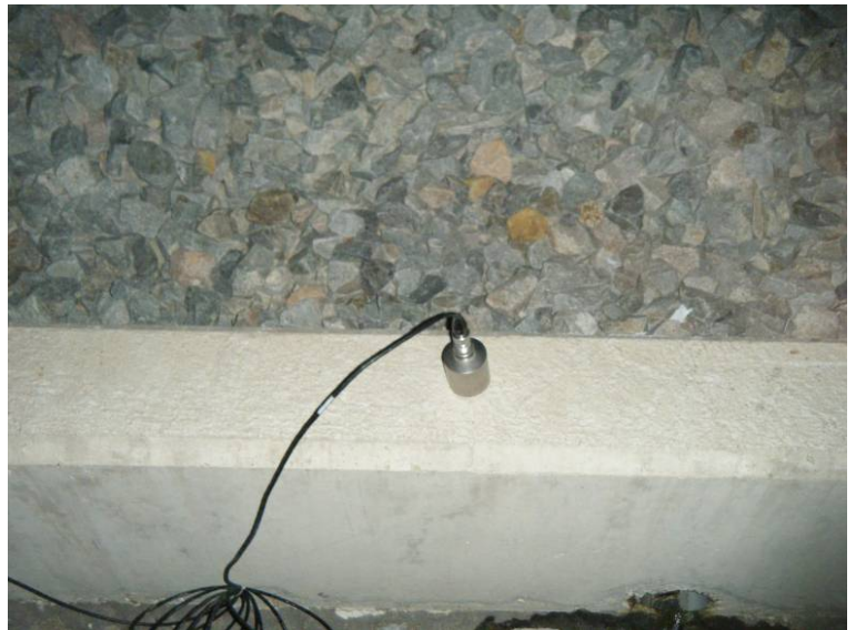
Fotografía N°10: Acelerómetro empleado en la prueba (B&K)
