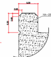
DETALLE IMPOSTA ESCALA 1:20
