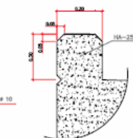
DETALLE IMPOSTA ESCALA 1:20
