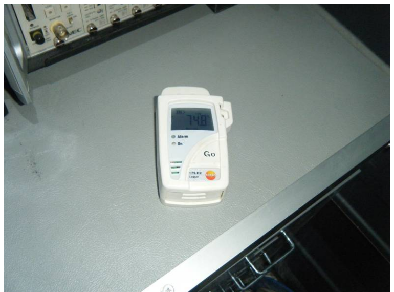
Fotografía N°5: Detalle del termohigrógrafo empleado
