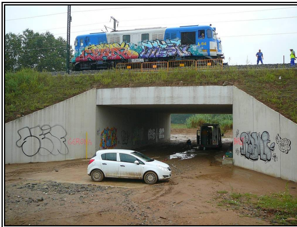
Nº 9.- Realización de prueba estática.
