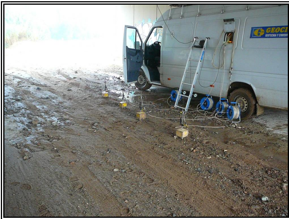
Nº 7.- LVDT's y equipo de instrumentación.
