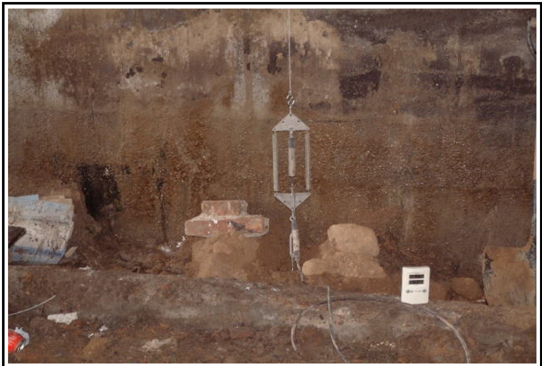
Foto 6: Detalle de potenciómetro en apoyo
