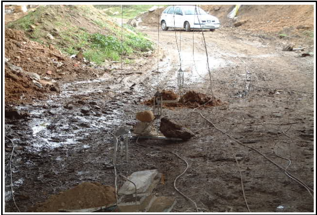
Foto 5: Línea de potenciómetros en centro de vano
