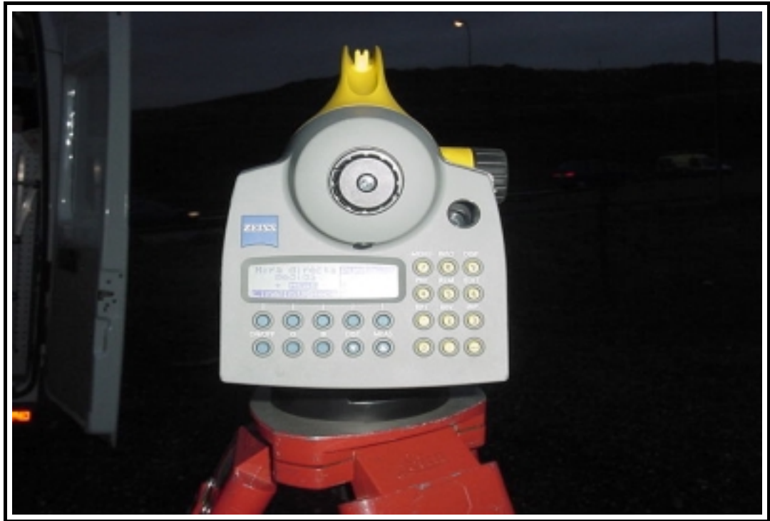
Foto 5: Detalle de nivel digital
