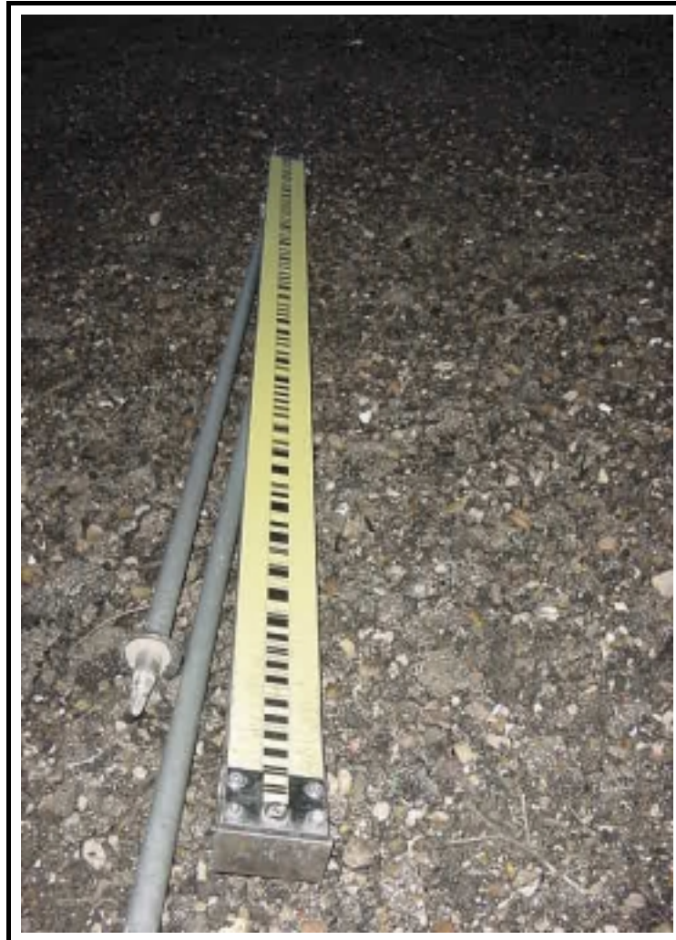
Foto 6: Mira ínvar de nivelación
