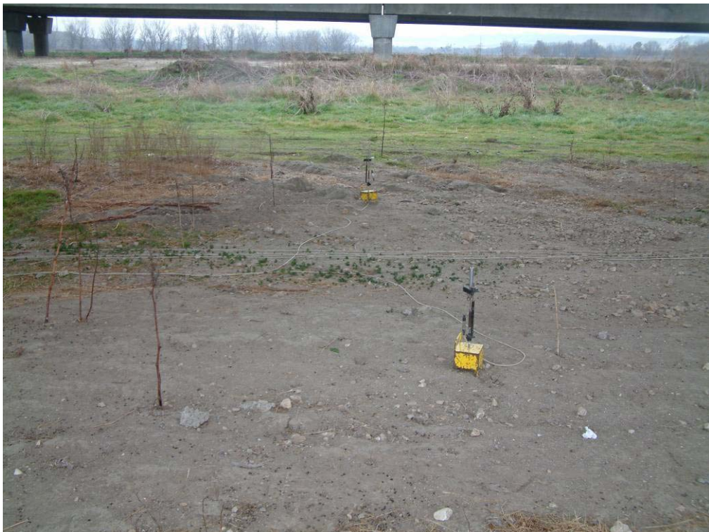
Nº 4.- Instrumentación con L.V.D.T's en centros de luz de vanos.
