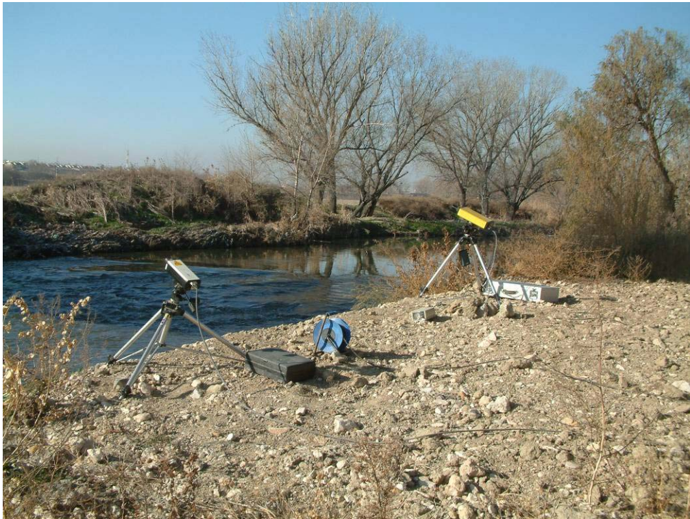
Nº 3.- Instrumentación con LASER en zona hiperestática sobre Río Manzanares.
